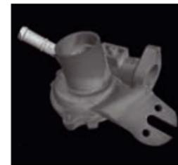
涡轮增压器铸造壳体
